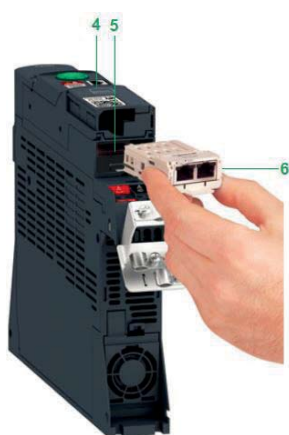
Ejemplo de instalación de un módulo de comunicación (6) en un ATV320 formato Libro
