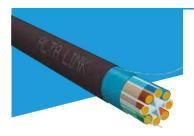
Diseñados para uso exterior, garantizando un alto desempeño de transferencia de datos en condiciones electromagnéticas y ambientales difíciles. Cuenta con blindaje de aluminio, embalaje PET TAPE, cruz y cable de drenaje.
